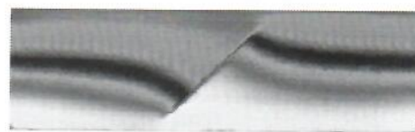
FIGURA 12. IMAGEN INFRARROJA DE LA PLACA DE COBRE AHORA CALENTADA DESDE ARRIBA Y ENFRIADA EN LA PARTE BAJA.
