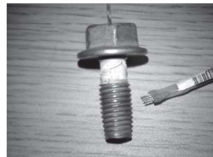
Figura 2. Tornillo autorroscante instrumentado con galgas extensiométricas.
