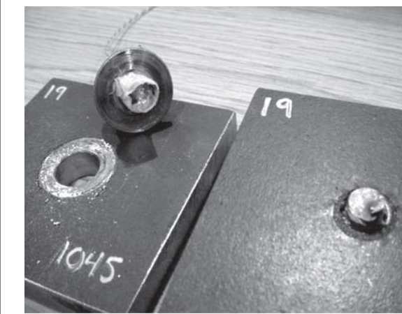
Figura 5. Fractura de tornillo en acero SAE 1045.
