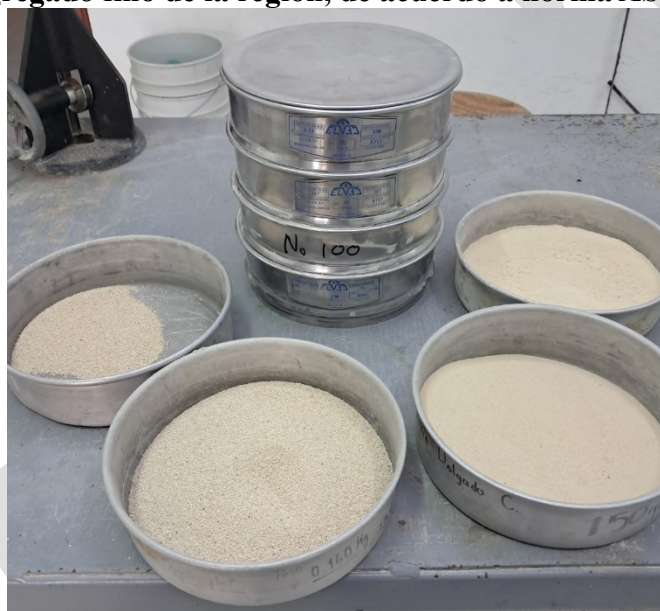
Figura 2 Cribado de agregado fino de la región, de acuerdo a norma ASTM C144, 2018
