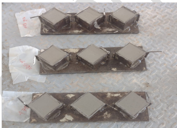
Figura 4 Preparación de cubos de mortero, de acuerdo con norma ASTM C109, 2021
