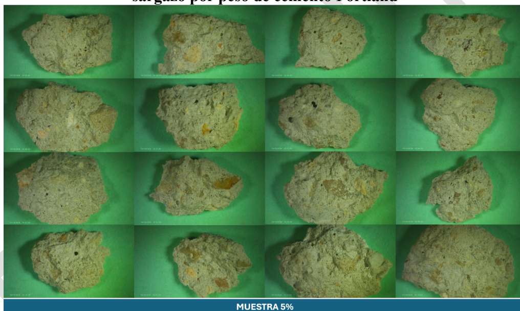
Figura 8 Matriz cementante de espécimen de mortero con sustitución de 5 % de ceniza de sargazo por peso de cemento Portland
