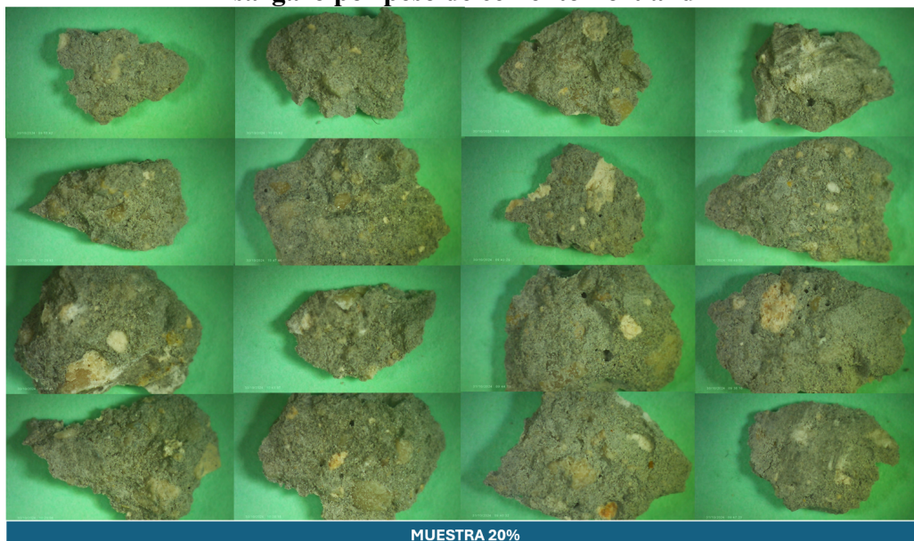
Figura 11 Matriz cementante de espécimen de mortero con sustitución de 20 % de ceniza de sargazo por peso de cemento Portland
