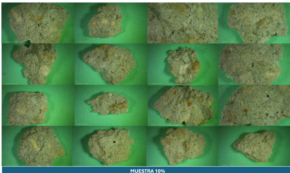
Figura 9 Matriz cementante de espécimen de mortero con sustitución de 10 % de ceniza de sargazo por peso de cemento Portland
