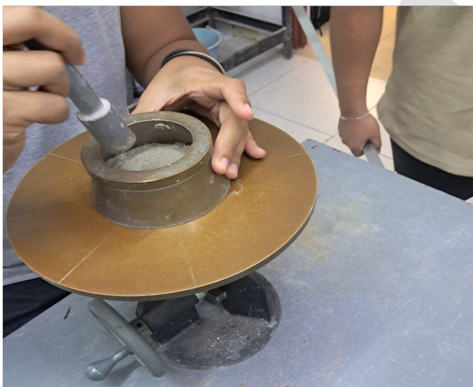
Figura 3 Realización de prueba de fluidez de morteros, de acuerdo a norma ASTM C1437, 2020
