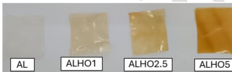
Figura 1 Películas a base de alginato de sodio a diferentes concentraciones de miel: AL, ALHO1, ALHO2.5 y ALHO5.
