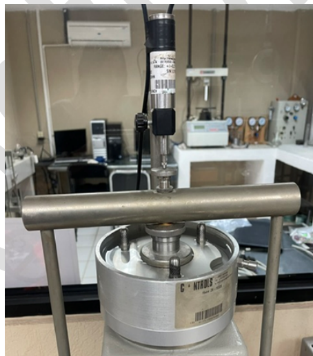
Figura 16 Muestra de suelo en consolidómetro unidimensional
